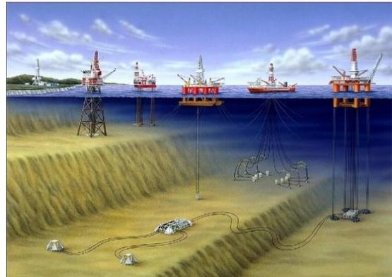
*Рис. 1. Платформы для бурения подводных нефтяных скважин*
