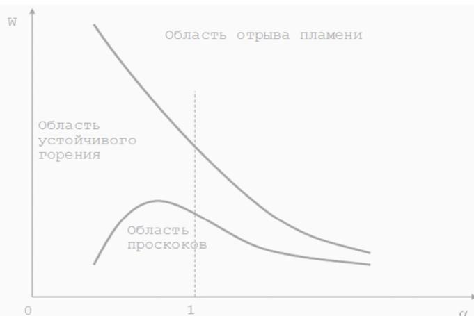
Рис. 1. Пределы устойчивого горения в горелках атмосферного типа:
