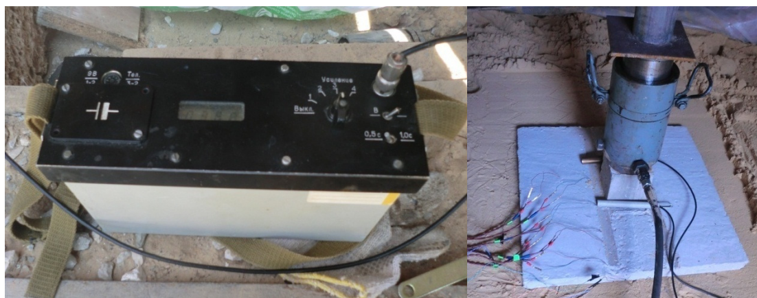
Рис. 1. Общий вид прибора «Одонис-3» и размещение антенн при испытании фундамента
