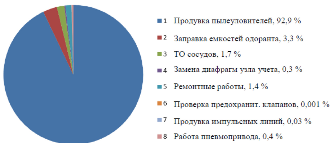
Рис. 1. Результаты расчета технологических потерь природного газа при эксплуатации ГРС, типоразмер БК-ГРС-80
