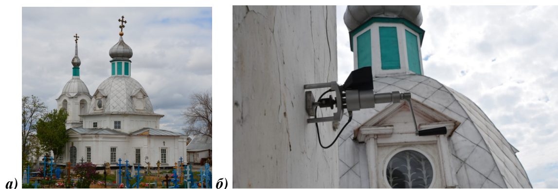
Рис. 1. Отбор образцов штукатурного раствора и измерение его адгезионной прочности: а) фотография храма Петра и Павла, с. Черный Яр; б) процесс установки адгезиометра на оштукатуренной поверхности
