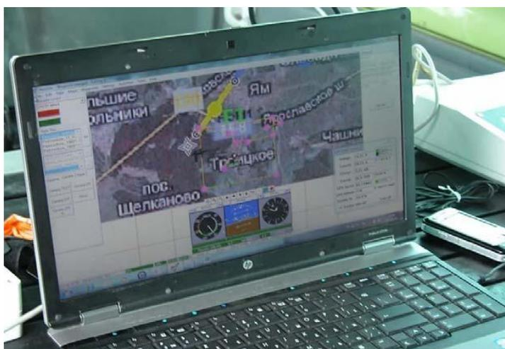
Рис. 5. Программа проектирования аэрофотосъемки и навигации БПЛА – Gorizon
