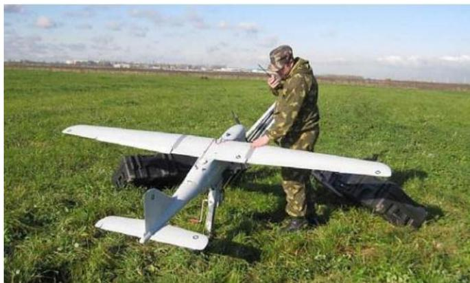
*Рис. 1. Предстартовая проверка БПЛА самолетного типа «Орлан-10»*
