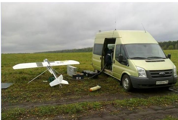
*Рис. 3. Наземный пункт управления БПЛА «Птеро-СМ»*
