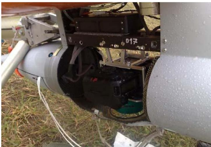
*Рис. 2. Цифровая фотокамера Canon EOS 5D Mark II*
