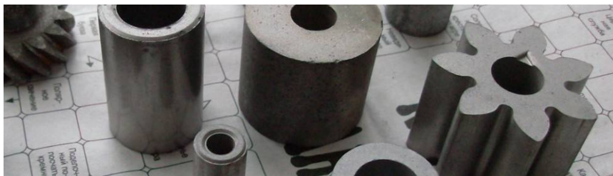
Фот. 2. Детали, полученные путем спекания металлического порошка
