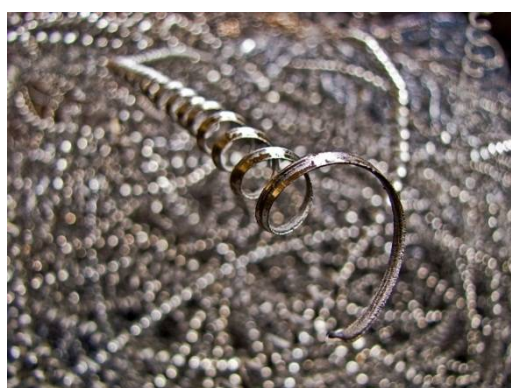
Фот. 3. Сливная (бесконечная) стружка, превращаемая в проволоку
