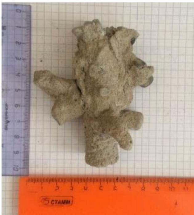
*Рис. 3. Грунтобетонный кластер корневидной формы (после отмывки)*
