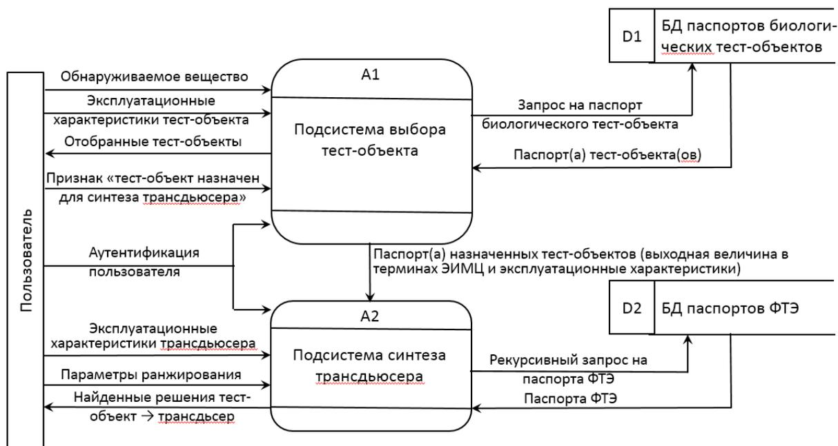
Рис. 2. Диаграмма потоков данных автоматизированной системы (DFD модель данных)
