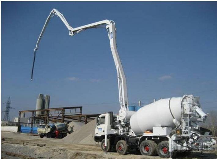
*Рис. 2. Подача бетонного раствора стационарными или подвижными бетононасосами (второй вариант исполнения)*
