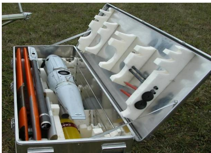
Рис. 4. Транспортный кейс БПЛА «Птеро-Е»
