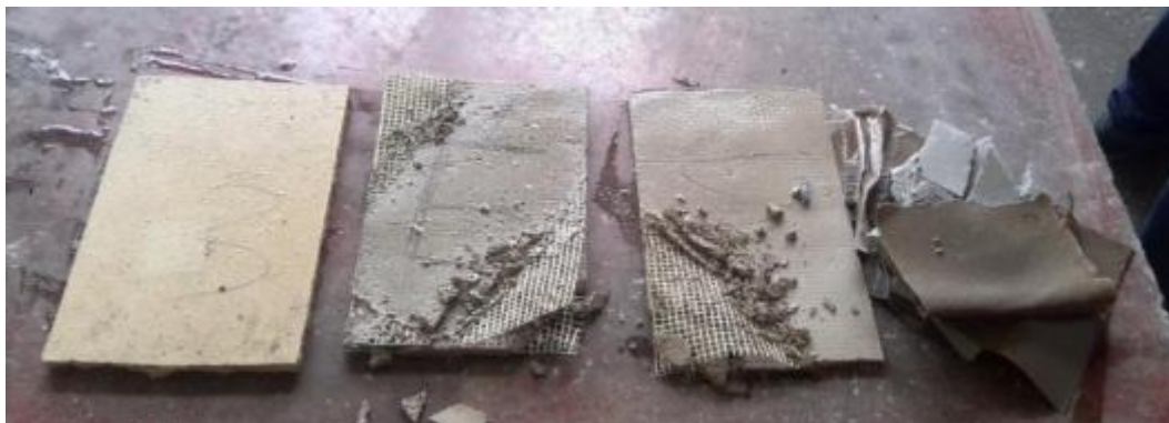
Рис. 4. Состояние образцов на 31-е сутки испытаний на водопоглощение
