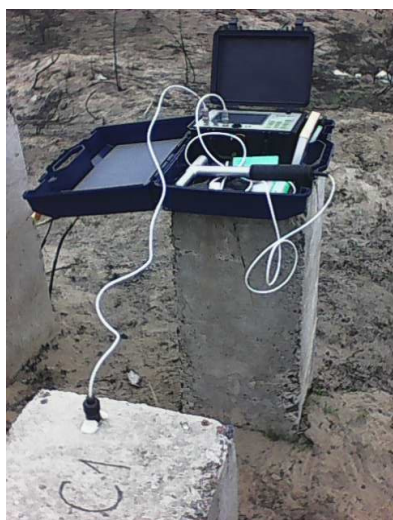
Рис. 2. Прибор ПДС-МГ 4 (натурные испытания)
