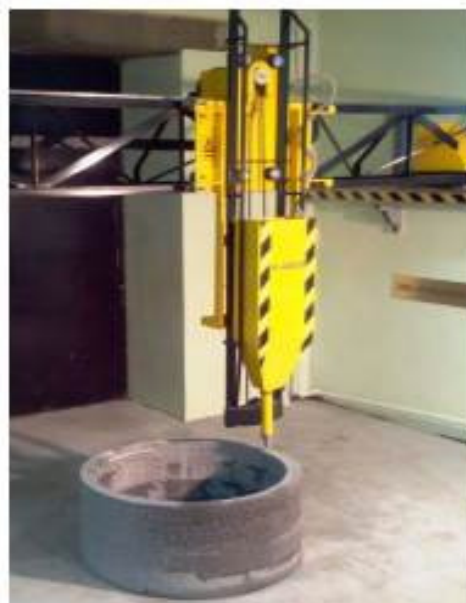
Рис. 5. Строительный 3D-принтер S-4063
