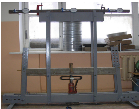
Рис. 1. Испытание балок на стенде
