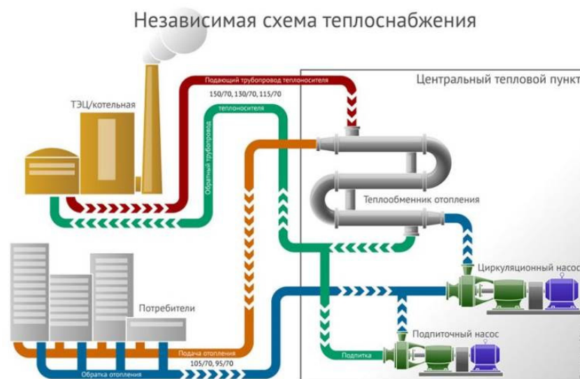
Рис. 1. Схема независимой системы теплоснабжения
