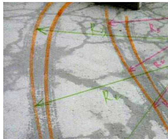
Рис. 4. Определение радиуса поворота автомобиля при нагрузке передней оси
