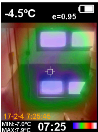
Рис. 7. Термограмма окон в подьезде жилого дома
