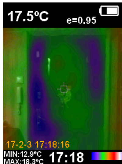
Рис. 6. Термограмма входной двери
