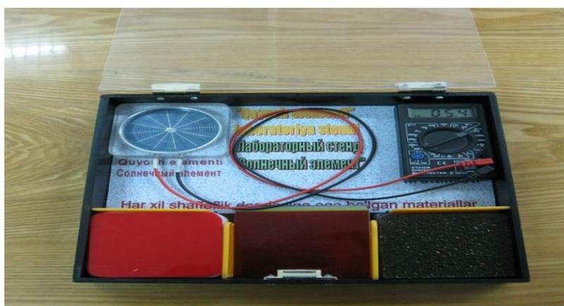
Рис. 1. Лабораторный стенд «Учебный солнечный элемент»
