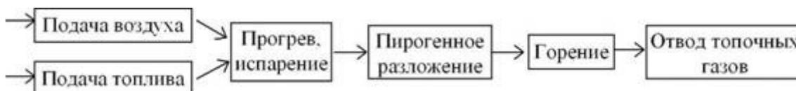
Поточная схема горения топлива в твердом агрегатном состоянии [1, 5, 6]:
