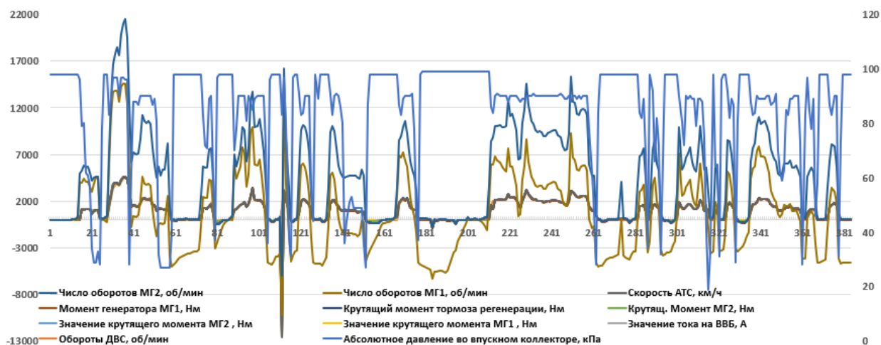
Рис. 3. Значения режимных параметров ГСУ в процессе движения автомобиля в диапазоне 0–466 с (ось абсцисс – номер стоп-кадра, через 1,22 с)
