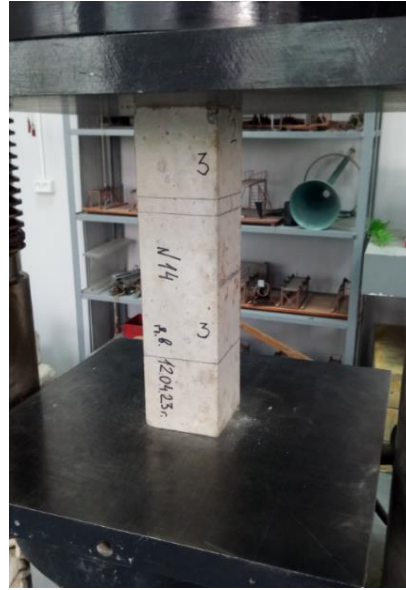
Рис. 8. Призма 10 × 10 × 40 см (состав бетона № 3) до разрушения
