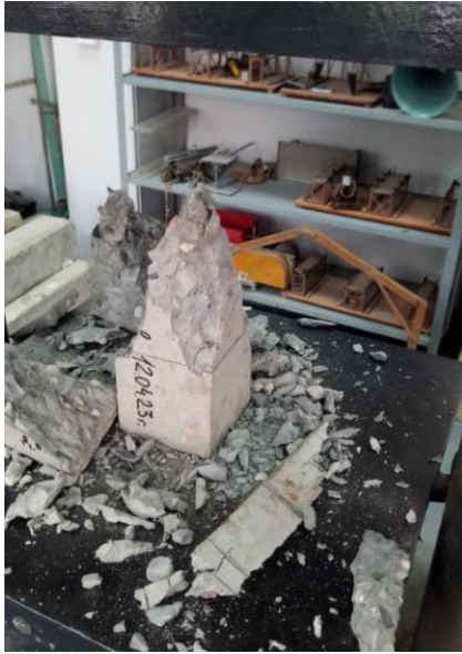
Рис. 7. Призма 10 × 10 × 40 см (состав бетона № 3) после разрушения
