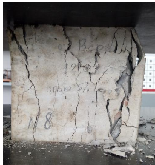
Рис. 6. Образец 15 × 15 × 15 см (состав бетона № 3) семь дней выдержки после разрушения
