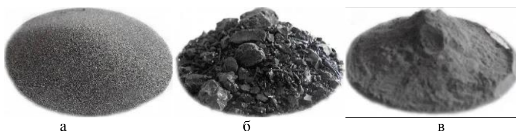
Рис. 1. Золошлаковые смеси: а) зола – унос; б) шлак; в) молотый шлак
