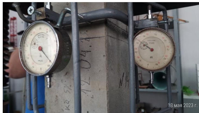
Рис. 9. Испытание призмы 10 × 10 × 40 см (состав № 3) для определения модуля упругости бетона
