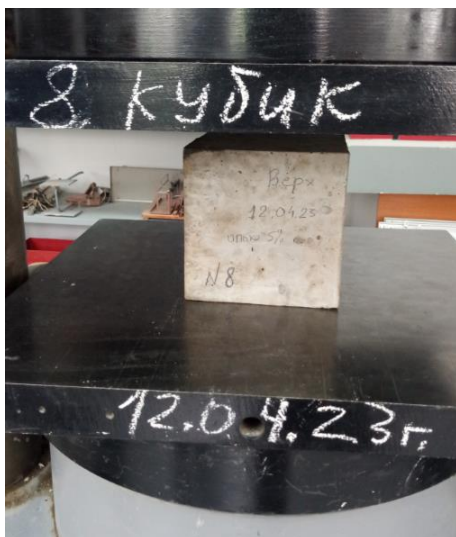
Рис. 5. Образец 15 × 15 × 15 см (состав бетона № 3) семь дней выдержки до разрушения
