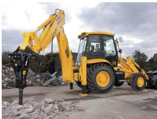
Рис. 4. Работа в забое экскаватора с раскатчиком
