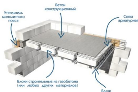
Рис. 1а. Сборно-монолитные перекрытия
