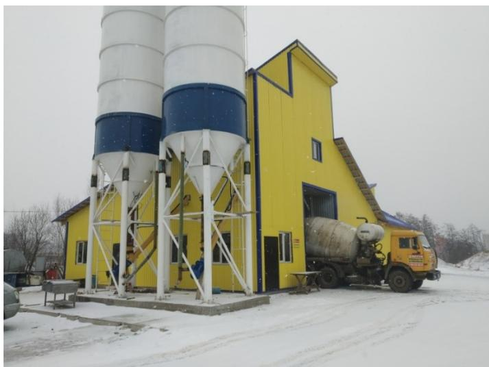
Рис. 2. Бетонный завод зимнего исполнения
