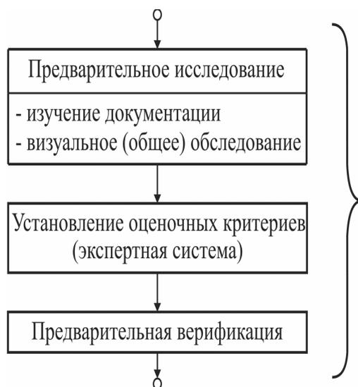
Рис. 2. Схема предварительного обследования технического состояния [1]
