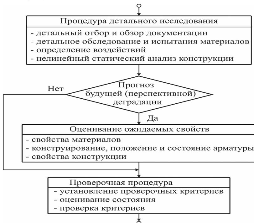
Рис. 3. Схема детального обследования технического состояния [1]
