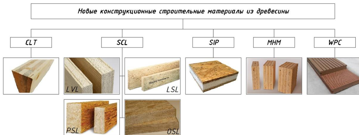
Рис. 1. Современные строительные материалы из древесины
