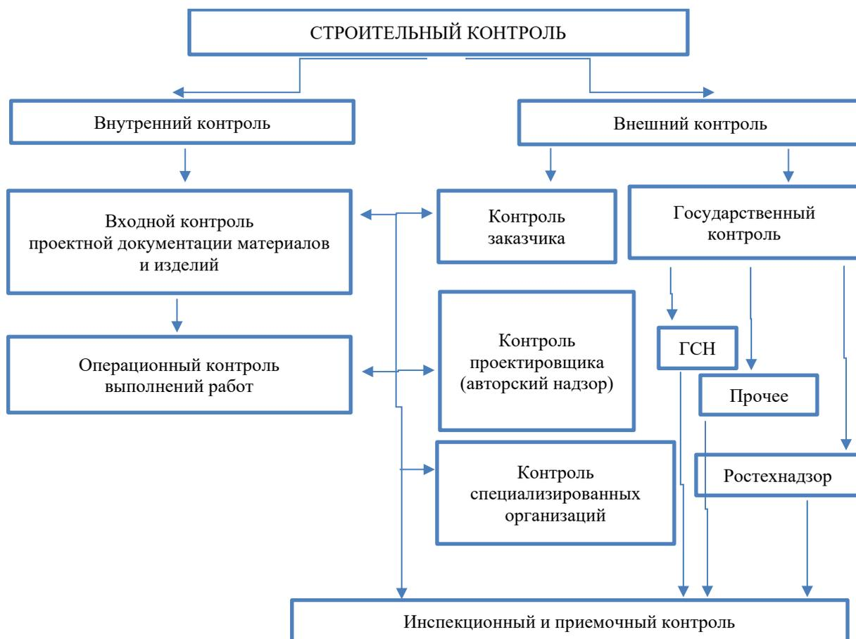
Рис. Схема осуществления строительного контроля и его формы
