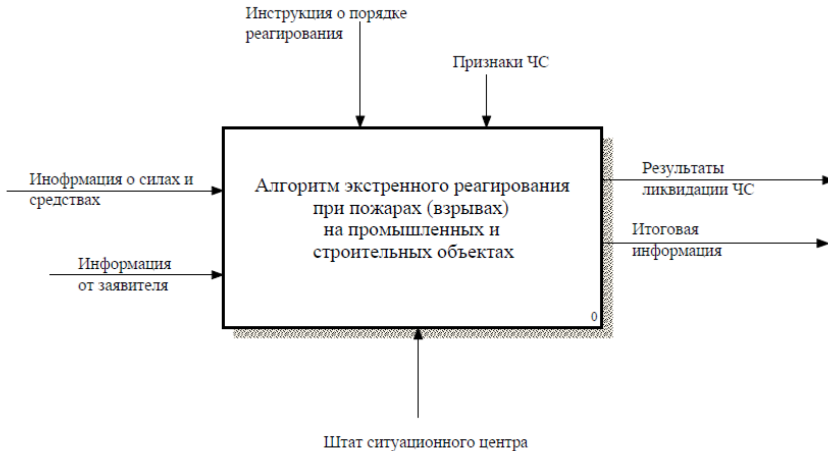
Рис. 2. Контекстная диаграмма функциональной модели процессов тушения пожаров в зданиях социально-бытового назначения
