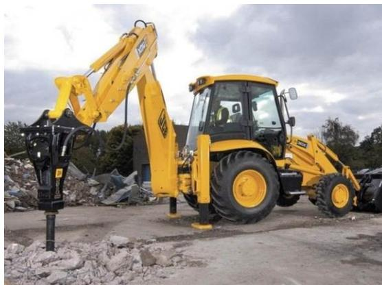
Рис. 4. Работа в забое экскаватора с раскатчиком
