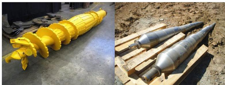
Рис. 3. Общий вид раскатчиков скважин
