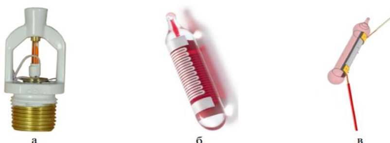
Рис. 2. Варианты исполнения электронагревателей для превентивной активации спринклера: а) четырехэлементный; б) спиральный; в) пленочный
