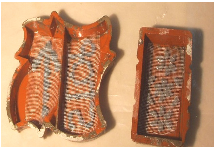
Рис. 3. Укладка стеклотканевой стальной сетки на дно формы с люминофорами в виде камней
