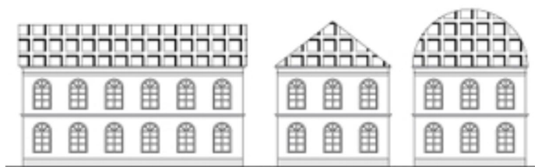
Рис. 1. Надстройка нового объема на историческое здание
