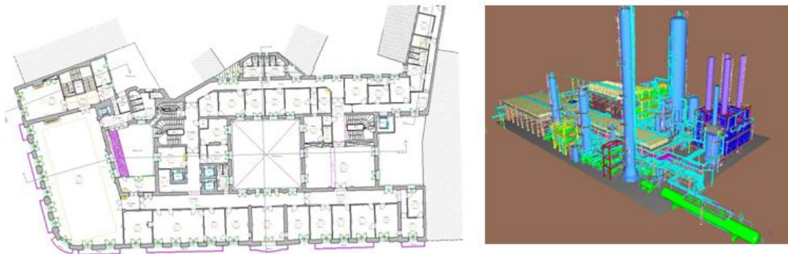
Рис. 4. Создание или восстановление исполнительной документации 2D/3D с возможностью добавления атрибутивной информации об объекте
