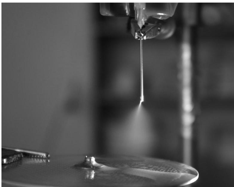
Рис. 1. Распыление водомасляной эмульсии
