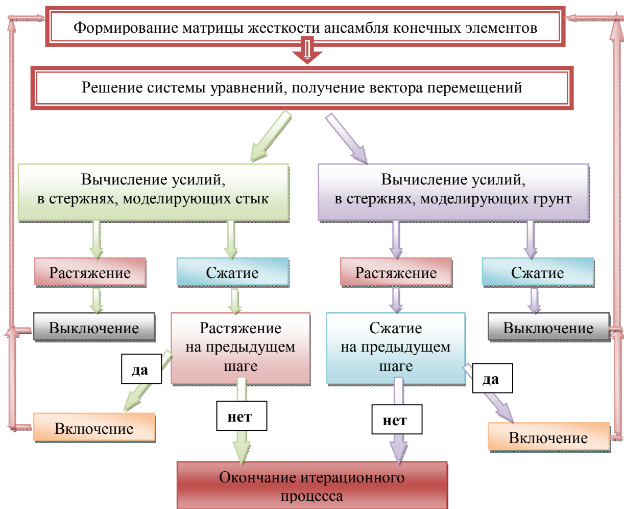
Рис. 3. Блок-схема вычислительного ядра системы расчета сборных тоннельных обделок
