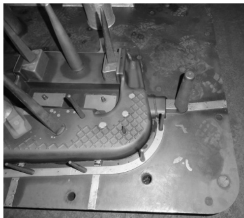
Рис. 3. Фрагмент модельной оснастки на плите низа с системой вентиляции наружной поверхности отливки
