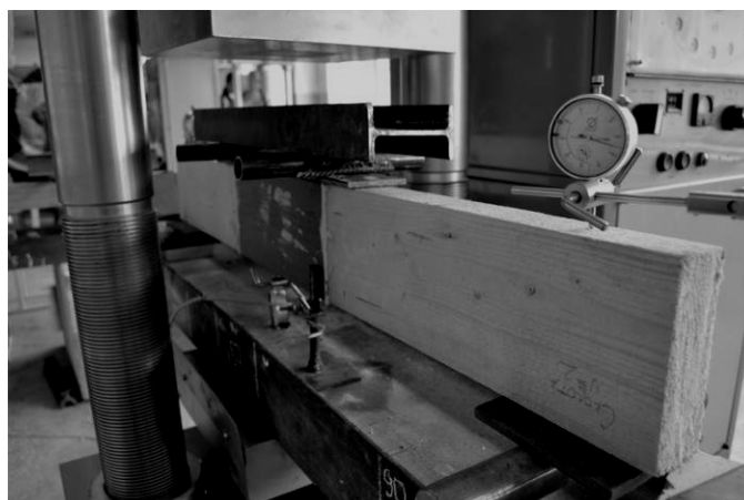
Рис. 3. Схема испытания деревянных балок
