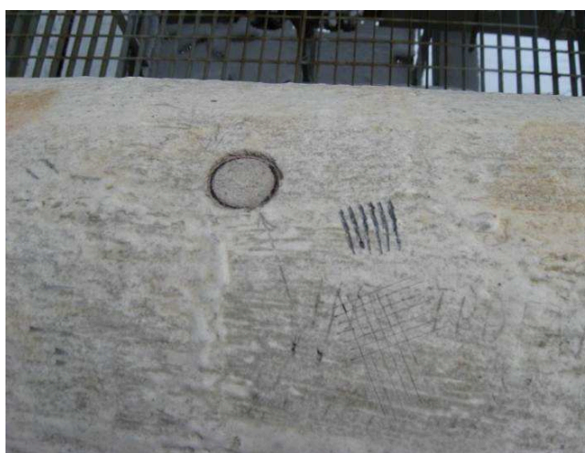
Рис. 3. Определение характеристик покрытия «Корунд»: твердости по карандашу и адгезии методом «грибков» и методом решетчатых надрезов
