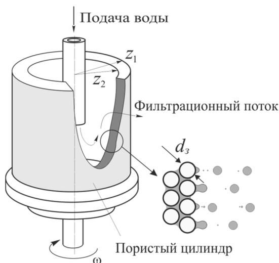
Рис. 1. Расчетная схема ПВР для определения скорости фильтрации
