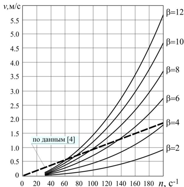
Рис. 2. Графики зависимостей (9) и (14) в диапазоне  $0 < n < 200 \text{ с}^{-1}$
