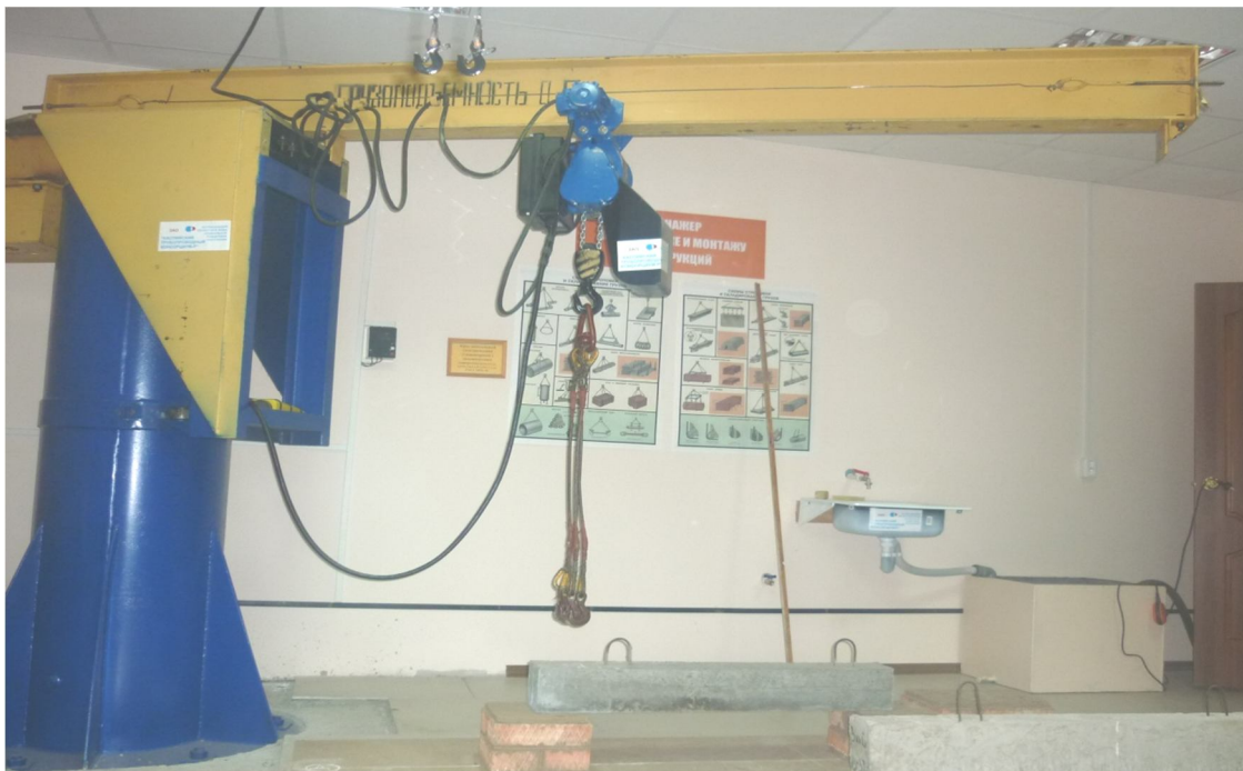
Рис. 3. Учебный тренажер на базе стационарного электрического консольного крана для ведения лабораторных работ по строительным специальностям
