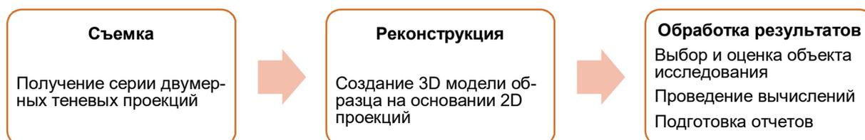
Рис. 1. Принципиальная схема томографических исследований
