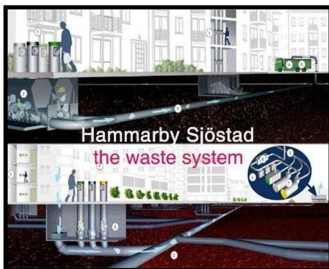
Рис. 1. Схема системы мусоропровода
