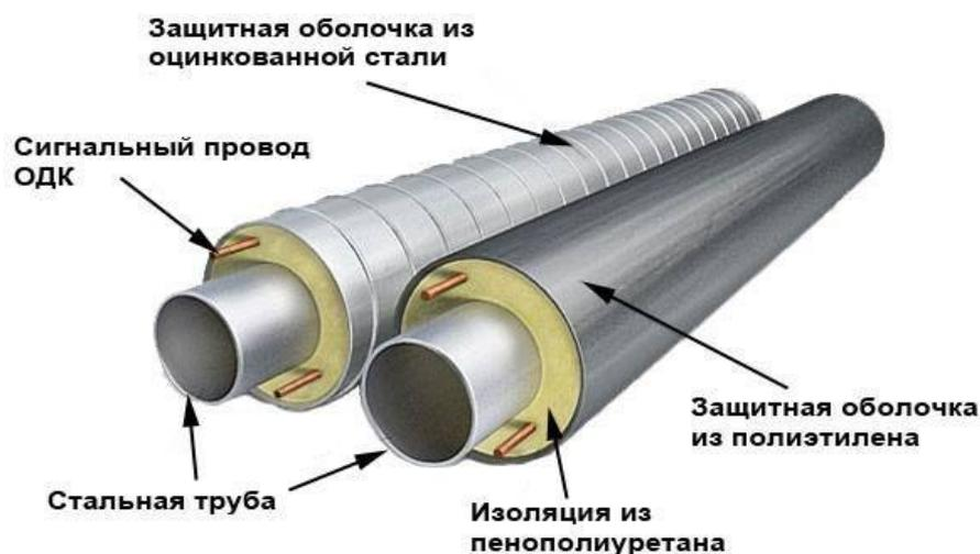
Рис. Устройство тепловой изоляции из ППУ
