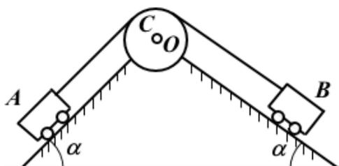
Груженная углем вагонетка  $A$  скатывается по наклонной плоскости с углом наклона  $\alpha$ , поднимая при помощи троса порожнюю такую же вагонетку  $B$ , движущуюся по наклонной плоскости с углом наклона
