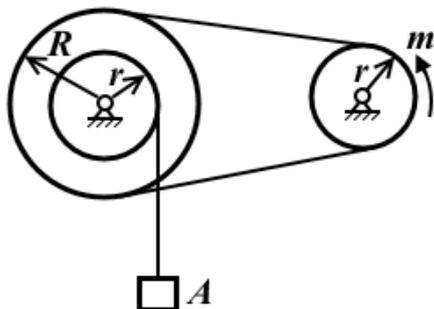
Груз  $A$  весом  $P$  поднимается при помощи троса, навитого на вал радиуса  $r$ . С валом жестко соединен шкив радиусом  $R$ . Подъем груза осуществляется с помощью цепной передачи к малому шкиву радиусом  $r$ , к которому приложен постоянный вращающий момент  $m$ . Вес большого шкива вместе с валом  $P_1$ , радиус инерции его относительно оси вращения  $r_{и}$ , вес малого шкива  $P_2$ , масса
