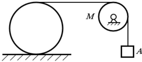
Однородный круглый цилиндр весом  $P$  обмотан тросом, к свободному концу которого, перекинутому через блок  $M$ , привязан груз  $A$  весом  $Q$ . В начальный момент система находилась в покое. Пренебрегая массами троса и блока, считая, что цилиндр катится по горизонтальной плоскости без скольжения, определить ускорение груза и скорость его после того, как он опустится на высоту  $h$ . Произвести вычисления, положив:  $P = 800 \text{ Н}$ ,  $Q = 200 \text{ Н}$ ,  $h = 2 \text{ м}$ .
