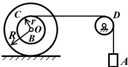
Груз  $A$  весом  $P$  посредством троса, переброшенного через неподвижный блок  $D$  и навитого на барабан  $B$ , заставляет колесо  $C$  катиться без скольжения по горизонтальной плоскости. Барабан  $B$  радиусом  $r$  жестко связан с колесом  $C$ , радиус которого  $R$ ; их общий вес  $Q$ , а радиус инерции относительно
