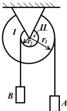
Два груза  $A$  и  $B$  весом  $P$  каждый, подвешенные при помощи тросов к барабанам  $I$  и  $II$  радиусов  $r_1$  и  $r_2$ , насаженных на общую ось, движутся под действием сил тяжести. Считая барабаны сплошными цилиндрами весом  $P_1$  и  $P_2$ , пренебрегая весами тросов, их деформацией, а также трением на оси барабанов, определить угловое ускорение барабанов и угловую скорость их после того, как груз  $B$  поднимается из состояния покоя на высоту  $h$ .
