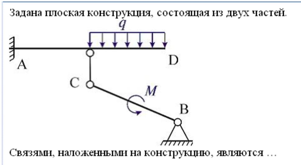
**Ответ:** стержень с шарнирами на концах; жесткая заделка; шарнирно-неподвижная опора
