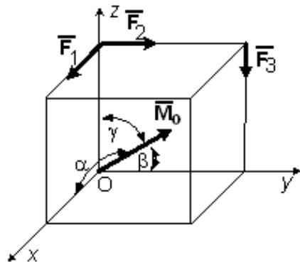
Угол, который образует главный момент данной системы сил с осью  $Ox$  равен  $\alpha = \arccos \dots$
