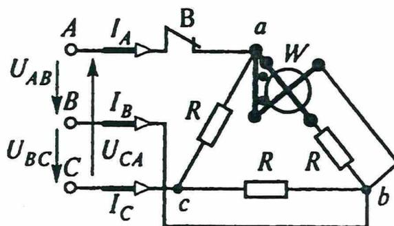
3. Трехфазный потребитель электроэнергии, который питается от сети с симметричным линейным напряжением  $U_{\text{л}} = U_{AB} = U_{BC} = U_{CA} = 220$  В, сопротивления фаз  $R = X_c = 220$  Ом. Определить фазные токи  $I_{\text{ф}}$  и показание ваттметра  $W$ .
