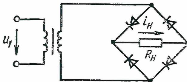
8. Чему равен ток  $I_H$  нагрузочного резистора сопротивлением  $R_H = 120$  Ом мостового выпрямителя, если напряжение на входе трансформатора  $U_{1m} = 100$  В; коэффициент трансформации  $n = 0,5$ , а сопротивление каждого полупроводникового диода  $R_{\text{пр}} = 10$  Ом. .
