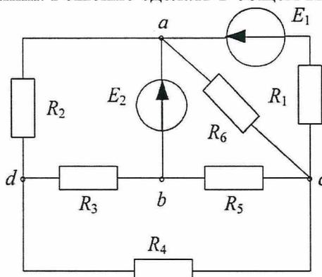
5. Суть метода узловых потенциалов для расчета параметров электрической цепи с использованием основ математики, физики, вычислительной техники и программирования.
