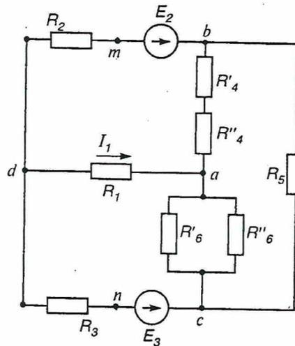
2. По схеме рассчитать комплексные сопротивления элементов и назвать методы защиты в условиях чрезвычайных ситуаций при работе с данными цепями. Круговая частота  $\omega = 314$  рад/с,  $R_2 = 20$  Ом,  $R_3 = 40$  Ом,  $L_1 = 64$  мГн,  $L_2 = 128$  мГн,  $C_2 = 159$  мкФ.
