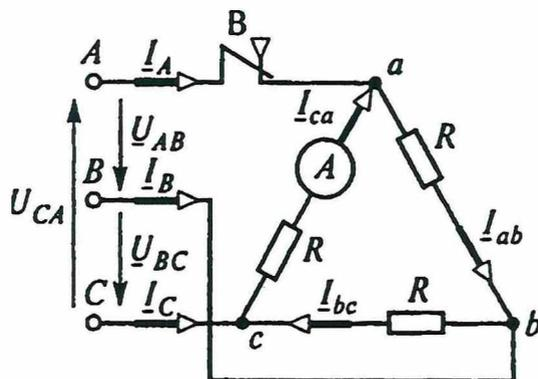
2. Трехфазный потребитель электроэнергии, соединенным треугольником, который питается от симметричной трехфазной сети с линейным напряжением  $U_{\text{л}} = 380$  В, с частотой  $f = 50$  Гц, сопротивление фаз потребителя  $R = 20$  Ом. Определить показания ваттметра при замкнутом и разомкнутом выключателе  $B$ .
