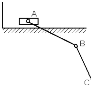
В механизме, изображенном на рисунке, соединение стержней – шарнирное, проскальзывание нитей и катков отсутствует, движение грузов – прямолинейное. Число степеней свободы механизма равно ...
