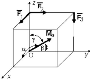
Угол, который образует главный момент данной системы сил с осью  $Ox$  равен  $\alpha = \arccos \dots$
