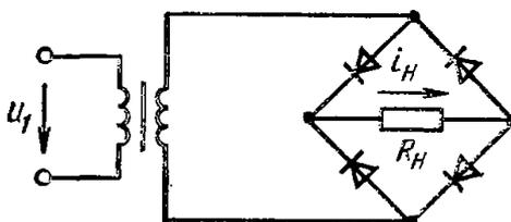
11. Чему равен ток  $I_n$  нагрузочного резистора сопротивлением  $R_n=120$  Ом мостового выпрямителя, если напряжение на входе трансформатора  $U_{1m}=100$  В; коэффициент трансформации  $n=0,5$ , а сопротивление каждого полупроводникового диода  $R_{пр}=10$  Ом. Сделать теоретическое обоснование вероятности возникновения потенциальной опасности .
