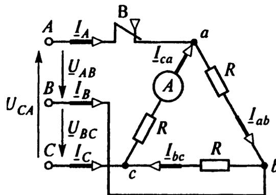
8. Назвать причины и условия возникновения чрезвычайных ситуаций и меры по их предупреждению трехфазным потребителем электроэнергии, соединенным треугольником, который питается от симметричной трехфазной сети с линейным напряжением  $U_{\text{л}} = 380\text{ В}$ , с частотой  $f = 50\text{ Гц}$ , сопротивление фаз потребителя  $R = 20\text{ Ом}$ . Определить показания ваттметра при замкнутом и разомкнутом выключателе  $B$ .
