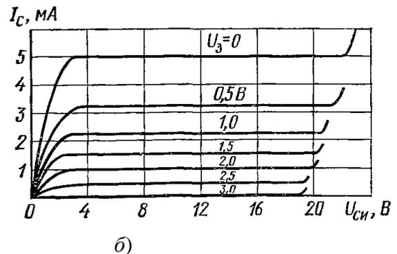
каскада (рис.а) на полевом транзисторе КП103Л, выходные характеристики  $I_C(U_{си})$  которого приведены на рис, б. Известно, что сопротивление  $R_c=2$  кОм,  $E_c=10$  В, напряжение смещения затвора  $U_{зи}=1,5$  В,  $f_H=50$  Гц. Сделать теоретическое исследование объекта и провести расчеты с использованием программно-аппаратных средств.
