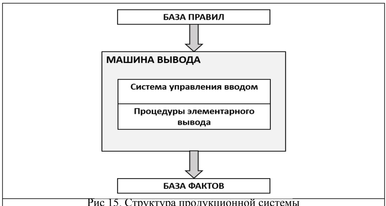
Рис 15. Структура продукционной системы
