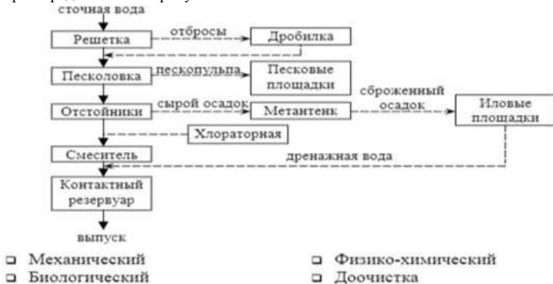
12. Какое сооружение биологической очистки скрыто под знаком вопроса в технологической схеме этой канализационной очистной станции?
