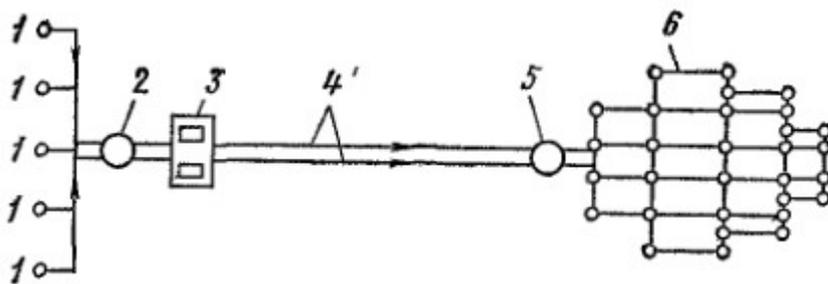
1. 1 — артезианские скважины, 2 — резервуар, 3 — насосные станции, 4 — трубопроводы, 5 — водонапорная башня, 6 — городская сеть водопровода
