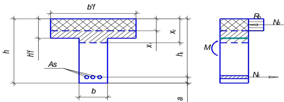
Условие задачи 10. На основе данных, приведенных в табл. 6, выполнить расчет прочности балки из тяжелого бетона по наклонному сечению, на действие поперечной силы. Из расчета определить: 1. по заданному диаметру поперечной арматуры ее шаг, 2. приняв максимально допустимый шаг по конструктивным требованиям, подобрать диаметр поперечной арматуры.
