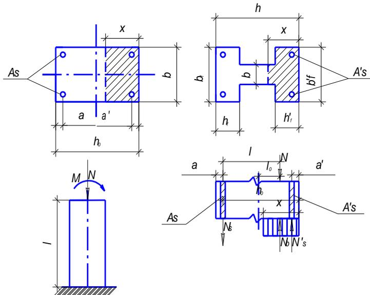
Условие задачи 12. Для балки, изготовленной из тяжелого бетона с тепловой обработкой, без предварительного напряжения арматуры требуется выполнить расчет на образование трещин.
