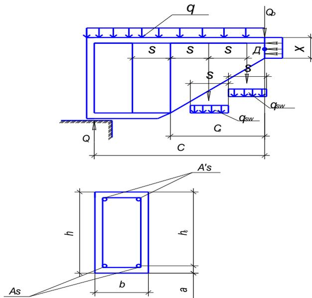
Условие задачи 11. На основе данных, приведенных в табл. 7, выполнить расчет площади арматуры внецентренно сжатого элемента из тяжелого бетона  $\alpha$  действие усилий  $N$ ,  $M$  от полной нагрузки и  $M_l$  от длительной нагрузки. Подобрать необходимое количество стержней требуемого диаметра и законструировать сечение.
