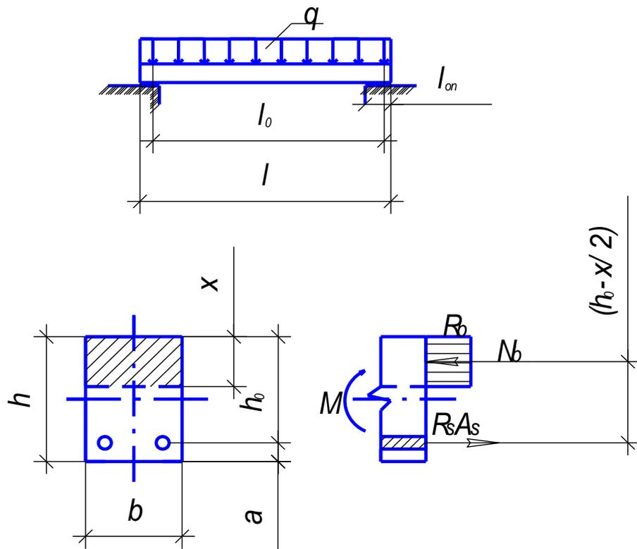
Условие задачи 8. Согласно приведенных в таблице 4 исходных данных, определить требуемую площадь арматуры для растянутой и сжатой зон нормального сечения прямоугольного профиля изгибаемого элемента из тяжелого бетона. Подобрать, необходимые диаметр и количество стержней, законструировать поперечное сечение.
