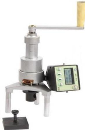
Рис. 3.1. Измеритель адгезии ПСО-МГ4
