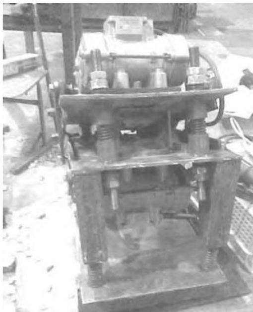
Рис. 3.6. Экспериментальный образец виброщековой дробилки
