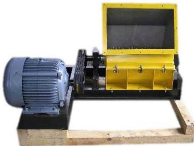
Рис. 2.7. Молотковая однороторная дробилка
