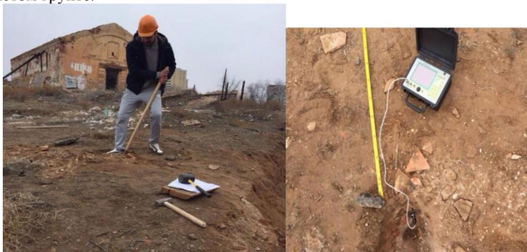
Рис.1.14. Получение поперечной волны на глинистом грунте
