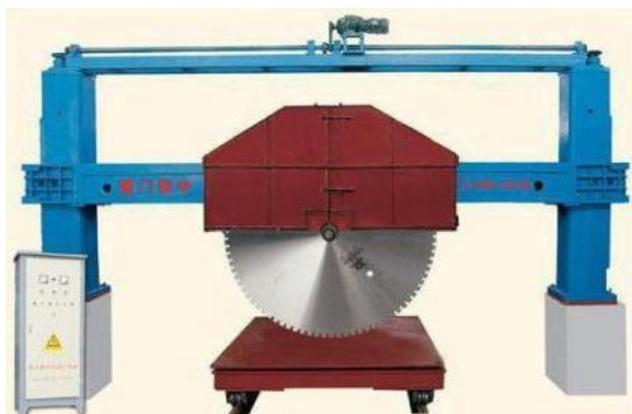
К преимуществам подобного камнерезущего оборудования относят его более низкую стоимость. Кроме этого, такие станки можно использовать для распиловки и первичной обработки достаточно больших глыб, при этом перемещения самих глыб не требуется. К недостаткам станков со свободным рабочим элементом относят низкую скорость обработки и резки камня.
