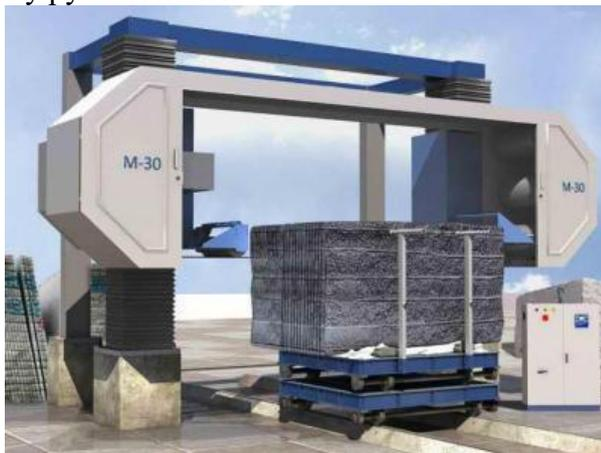
В проволочном оборудовании резка камня осуществляется тонкой проволокой с алмазным покрытием, которая при резке перематывается с одной бобины на другую. После заканчивая проволоки на бобину, вращение кассет начинается в другую сторону и процесс пиления продолжается.
