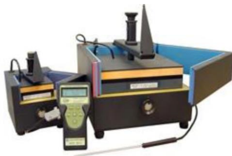
Рис. 3.3. Измеритель теплопроводности методом теплового зонда по ГОСТ 30256 ИТП-МГ4 «Зонд»
