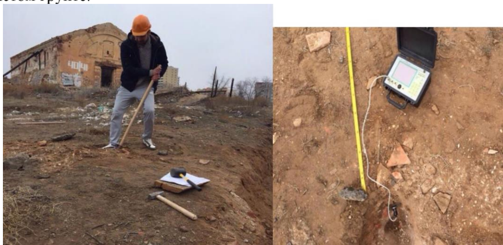
Рис.1.14. Получение поперечной волны на глинистом грунте
