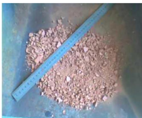
Рис. 3.9. Исходный материал и продукт измельчения экспериментального образца виброконусной дробилки
