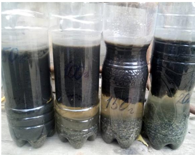
Состояние осадка после 4х часового отстаивания
