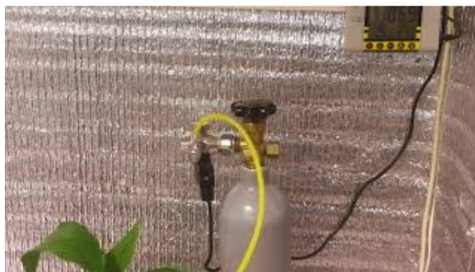
Рис. 2. Автоматически регулируемая подача ДОУ
