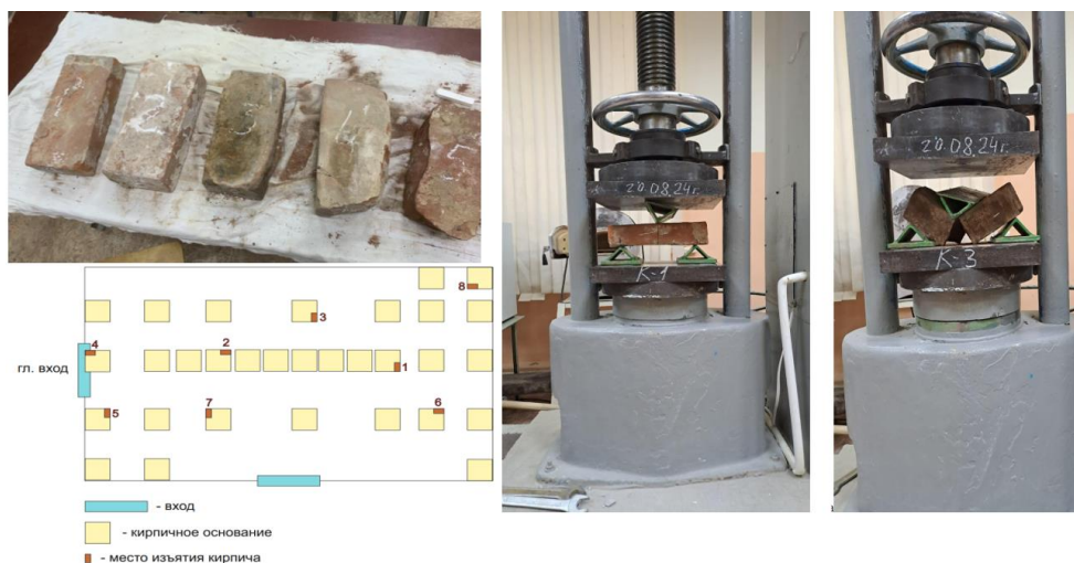
Рис. 14. Лабораторные испытания на прочность и изгиб изъятых в столбах фундаментов образцов кирпичей
