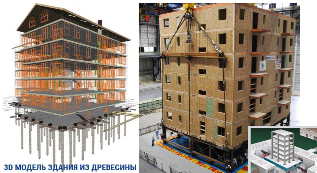
Рис. 2. Испытание многоэтажных зданий из деревянных конструкций в Японии [1]
