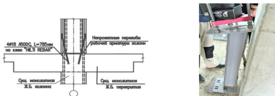
Рис. 3. Вклейка наклонной арматуры для компенсации перегибов вертикальной рабочей арматуры
