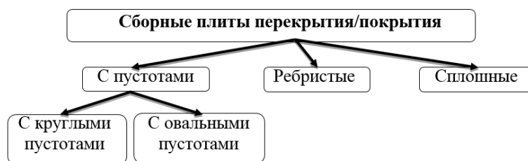
Рис. 1. Классификация плит перекрытия (покрытия) заводского изготовления
