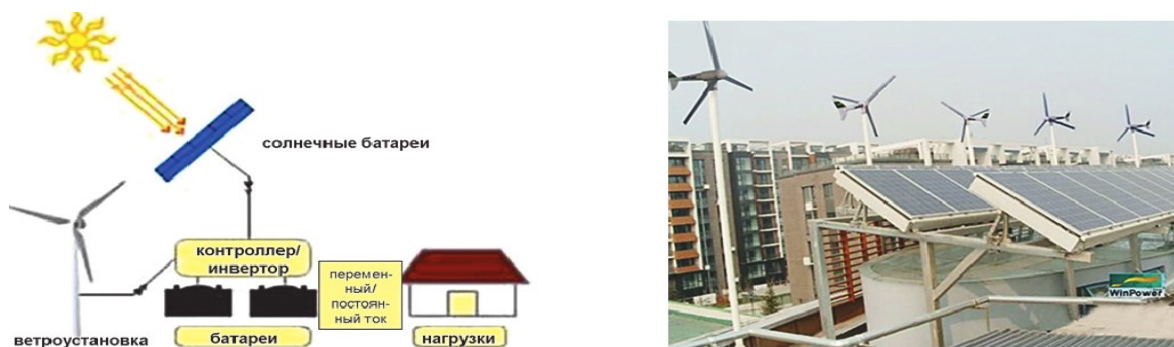
Рис. 1. Обобщенная схема и вид гибридной системы на основе ВИЭ
