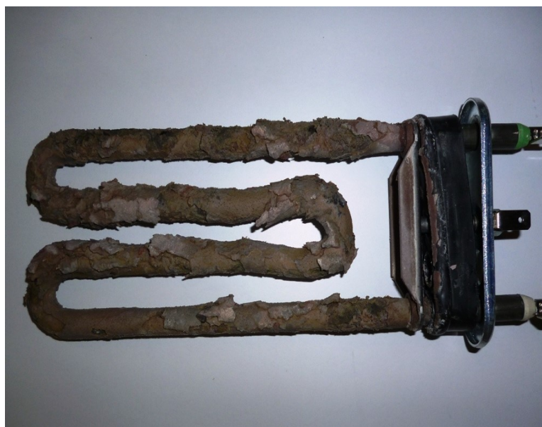
Рис. 2. ТЭН после 16 дней работы в проточной воде
