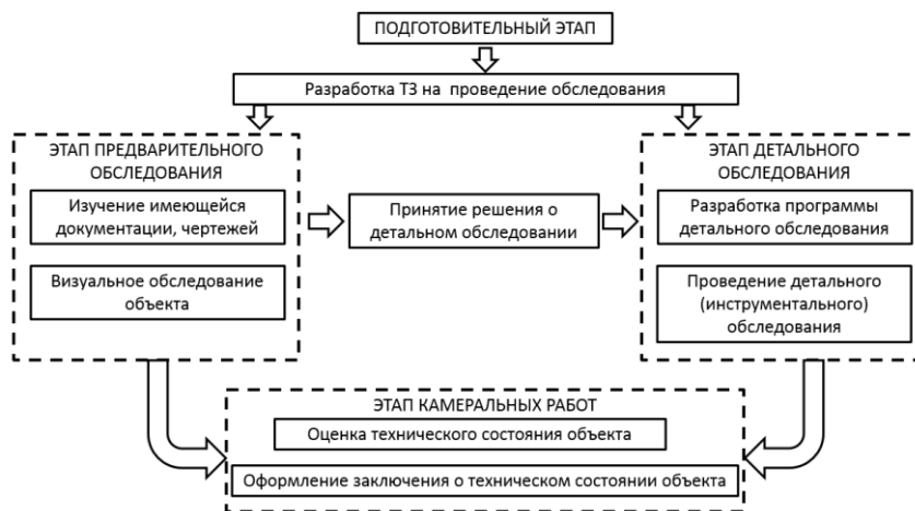
Рис. 1. Процесс проведения обследования зданий и сооружений
